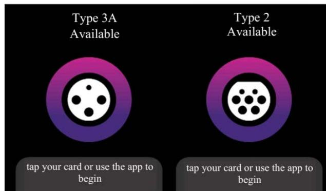
Zunächst muss sich der Nutzer mit der RFID-Karte oder einer entsprechenden APP ausweisen. Bringen Sie die RFID-Karte in die Nähe des Lesegeräts und warten Sie, bis sie akzeptiert wird; wenn sie akzeptiert wird, erscheint für einige Augenblicke die folgende Anzeige auf dem Display:
